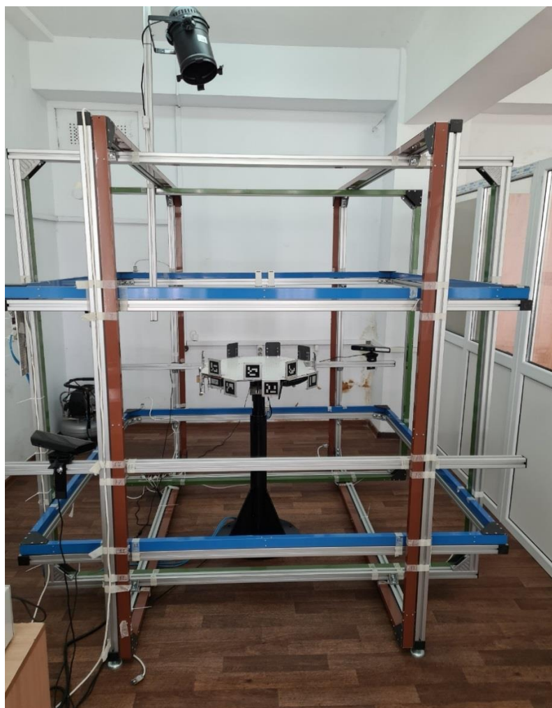
5 – сурет. Салыстырмалы қозғалысты имитациялау және SX-025 наноспутниктерін бағдарлау және тұрақтандыру жүйелерін пысықтау стенді
